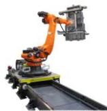
目前，德珂斯七轴有两种导向支撑形式：直线导轨/滚轮组。定位精度±0.1，重复定位精度 ±0.05，速度可达 2m/s，加速度可达3m/s<sup>2</sup>，负载等级分为:(1T/2T)3T/4T/5T。且满足客户实际现场需求，提供增高台的解决方案。
